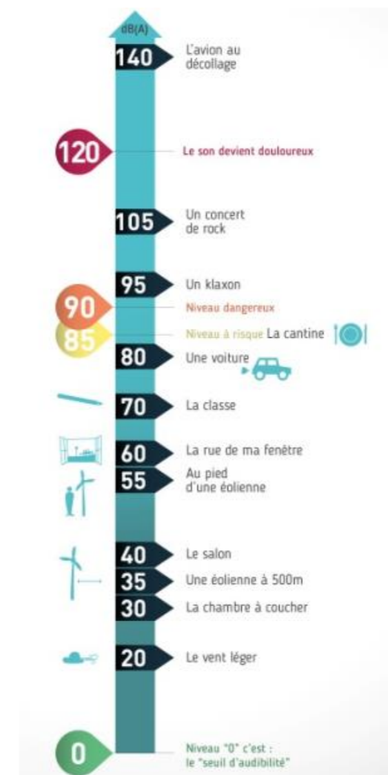
Figure 116 : Echelle de bruit (Source : France Energie Eolienne)
